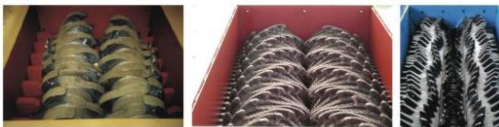
Сурет 2.2 - Ірі, орта және ұсақ ұсатқыштардың роторлы Bedeschi фирмасының ұсақтаушы
