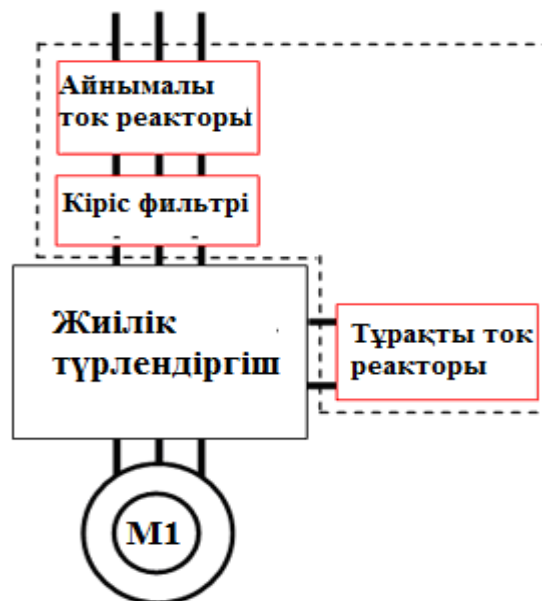
Сурет 3.6 - Жиіліктік электр жетегінің қуат бөлімінің функционалдық сызбасы
